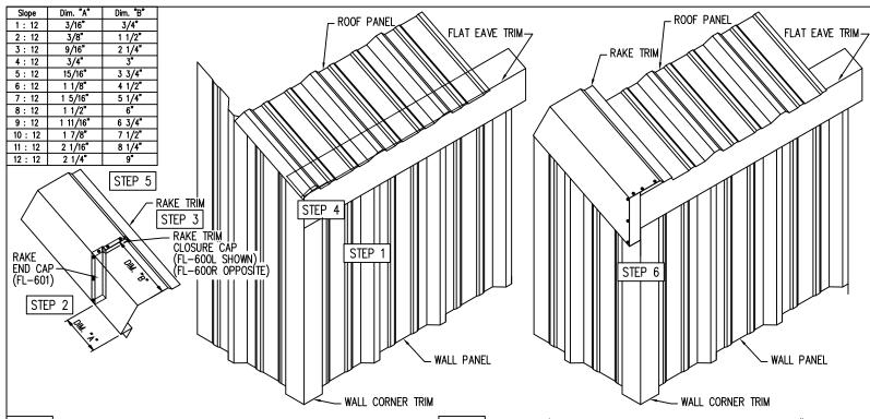
STEP 1 INSTALL FLAT EAVE TRIM IN BETWEEN THE ROOF PANEL AND LOW EAVE MEMBER. BE SURE THE END OF THE FLAT EAVE TRIM IS FLUSH WITH THE WALL CORNER TRIM.
